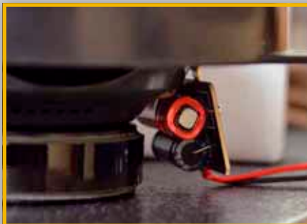
Die Tieftöner sind ebenfalls mit 12 dB/Okt getrennt
