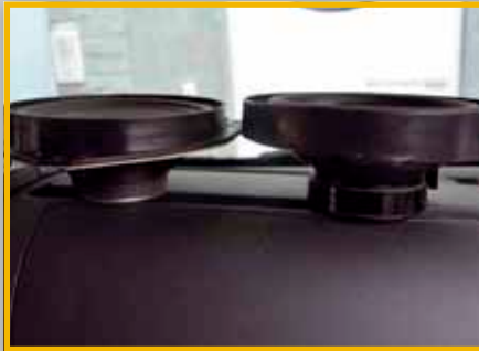
Original (links) und Axton (rechts): Gut zu erkennen ist der deutlich kräftigere Antrieb des Axton-Chassis
