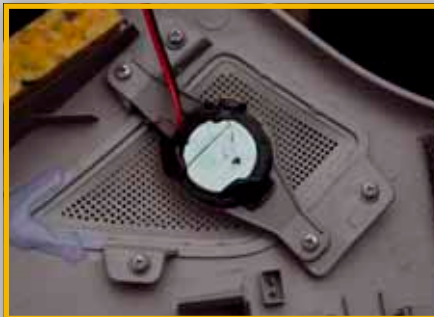
Der Hochtöner wird in die originalen Plätze geclipst. Etwas Heißkleber garantiert dauerhaften Halt
