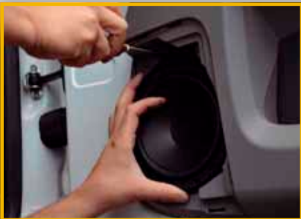
Der Tieftöner passt ohne weitere Adapter in den Originalplatz in den Türen
